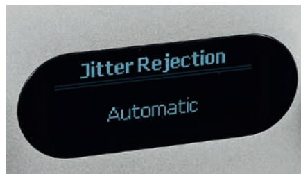
Audiolab wykorzystał potencjał samej kości przetwornika C/A i uruchomił szereg dodatkowych funkcji, w tym algorytm redukujący zniekształcenia jitter.
